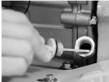
Rys. 5 – Sprawdzanie poziomu oleju w silniku
