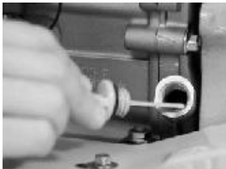
Fig. 4 – Verificarea nivelului de ulei al transmisiei
