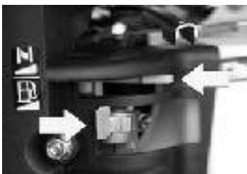
Fig. 8 – Robinet essence et starter
