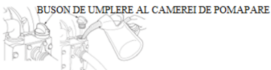
Bouchon de remplissage de la chambre de pompage
