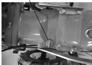
1. Ábra – Hajtóműolaj-sztint ellenőrzése
