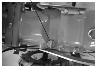
Sl. 5 –Proveravanje nivoa ulja u menjaču
